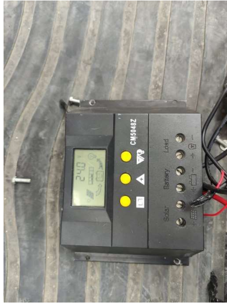
Figure 4-4- التأكد من بداية الشحن للبطارية على منظم الشحن قبل التثبيت
