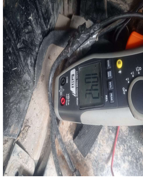
Figure ٣-١٠ أ- التيار الذي تم قياسه باستخدام الكلامب ميتر، ب- الجهد الذي تم قياسه باستخدام الملتيميتر
