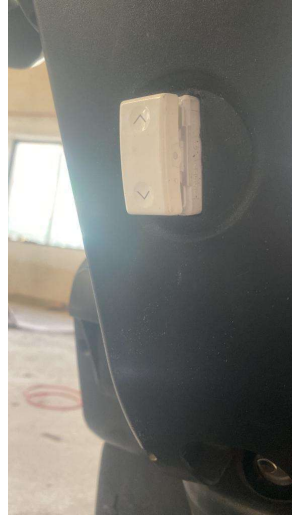
Figure ٤-٦ مفتاح التبديل بين النظام الاصيلي للشحن والنظام الشمسي
