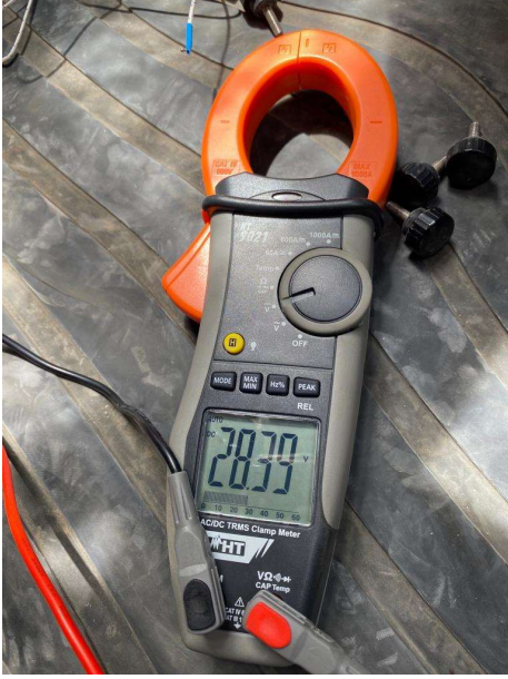
Figure ٣-١٠ أ- التيار الذي تم قياسه باستخدام الكلامب ميتر، ب- الجهد الذي تم قياسه باستخدام الملتيميتر
