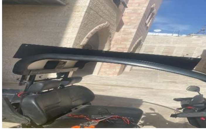
Figure ٣-١١ الالكابوند الذي تم اضافته حول اطار العربة
