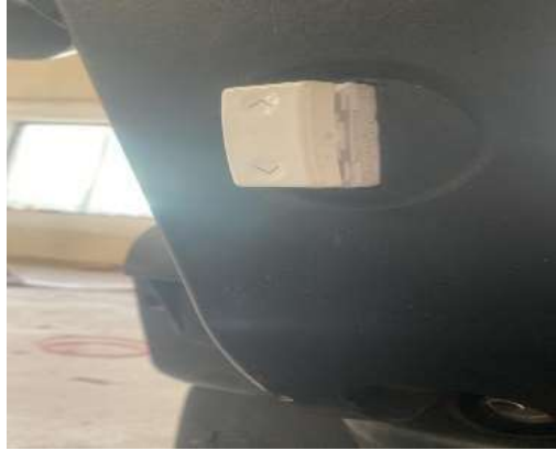
Figure ٣-٨ المفتاح اللازم لتحويل الشحن من الألواح الشمسية ومن الشاحن من الشبكة
